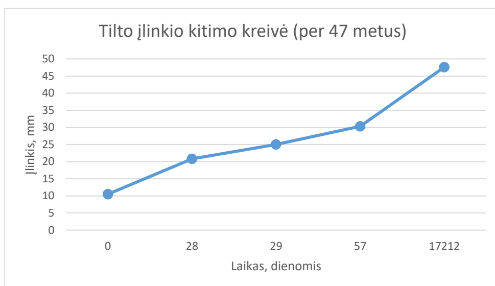
30 pav. Tilto įlinkio kitimo kreivė per pirmuosius 47 metus
