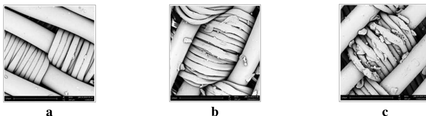
1.7 pav. Varginimo ciklų skaičiaus įtaka austos medžiagos struktūrai: a) kontrolinis bandinys; b) po 26 \cdot 10^6 ciklų; c) po 100 \cdot 10^6 ciklų [73]
