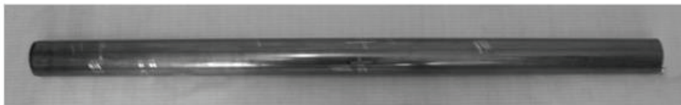
2.2 pav. Ignalinos AE KK vamzdžio dalis, naudota cirkonio lydinio mechaninių savybių, irimo parametrų eksperimentiniams tyrimams bei hidridų matmenų matavimui
