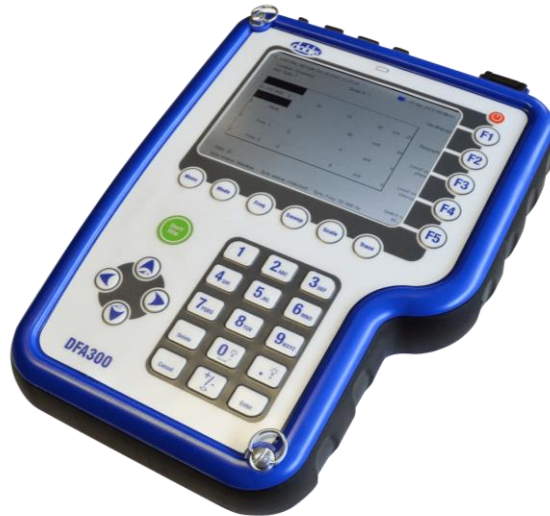
18 pav. Eksperimentu metu naudotas dalinių išlydžių matuoklis Doble DFA 300
