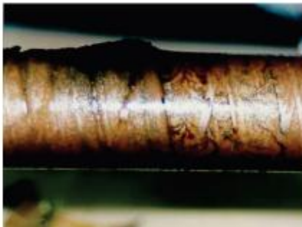
4 pav. Popieriaus alyvos izoliacija paveikta dalinių išlydžių [6]
