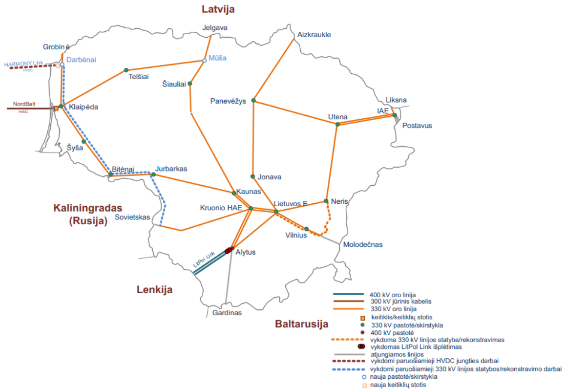
30 pav. Perspektyvinė 2028 metų Lietuvos perdavimo tinklo schema
