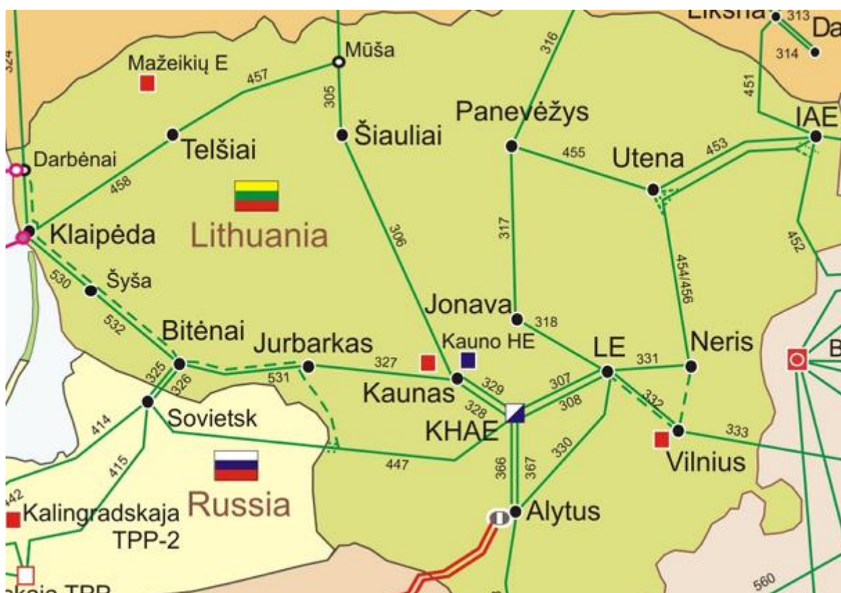
20 pav. Lietuvos perdavimo tinklo principinė schema
