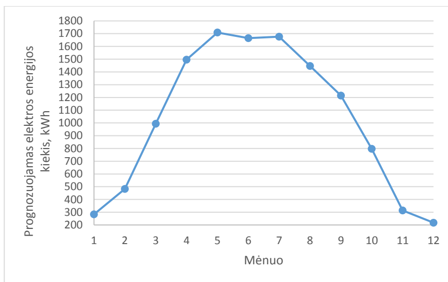
3.7 pav. 12,09 kW saulės elektrinės sudarytos iš „stiklas/plėvelė“ saulės modulių generuojama elektros energija atskirais mėnesiais, kWh
