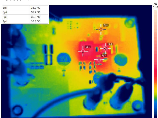
5.2.3 pav. LM5155EVM-BST modelis šiluminių bandymų metu, U_{in} = 6 \text{ V} , I_a = 0,87 \text{ A}
