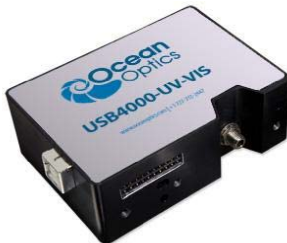
2.6 pav. OCEAN OPTICS USB4000 UV-VIS spektrometro matavimo blokas
