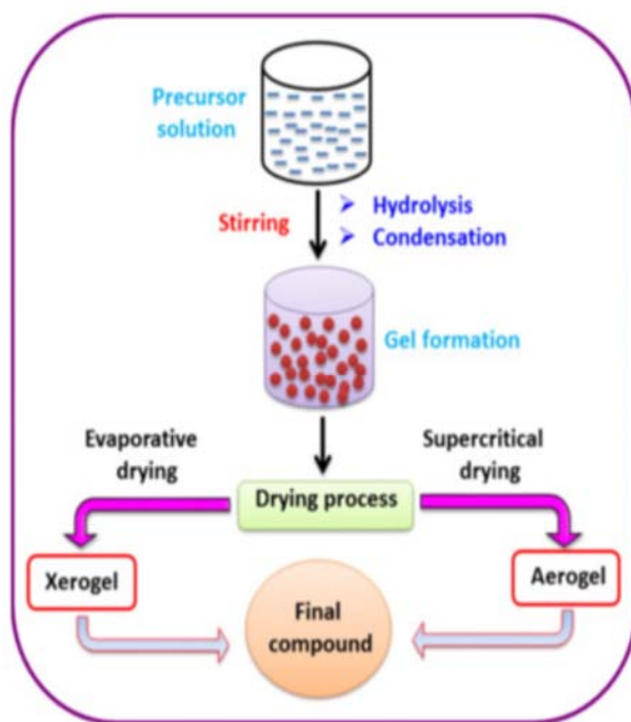
1.22 pav. Sol-Gel metodo principinė schema [49]
