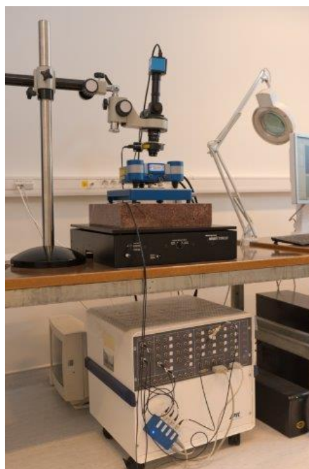
21 pav. Atominių jėgų mikroskopo (JPK NanoWizard 3) sistema [55]
