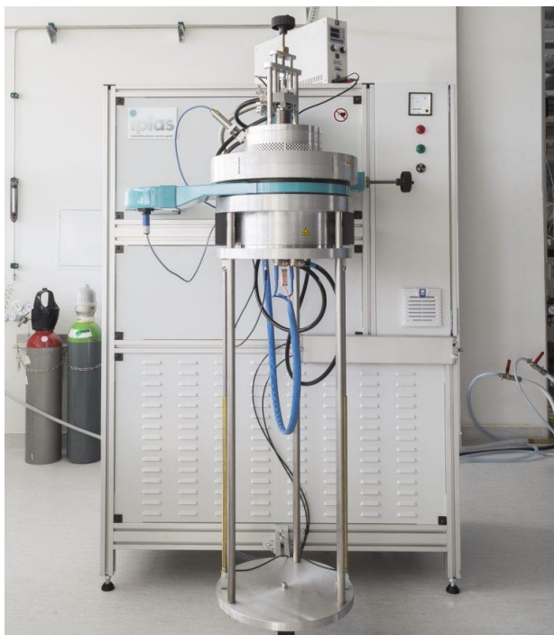
18 pav. Mikrobange plazma aktyvuoto cheminio nusodinimo iš garų fazės sistema Cyrannus I-6 [50]
