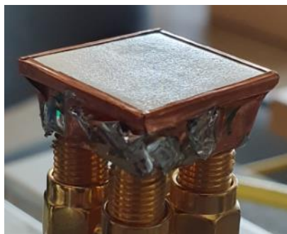
26 pav. 4 aktyvių elementų feroelektretinio ultragarsinio keitiklio struktūra
