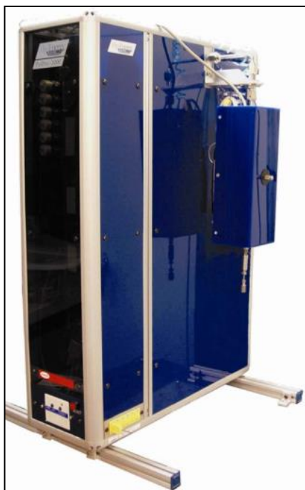
18 pav. Hy-Energy PCTPro–2000 įrenginys su MicroDoser bandinio laikikliu [99]
