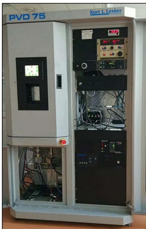
14 pav. Magnetroninio garinimo sistema Kurt J. Lesker PVD 75
