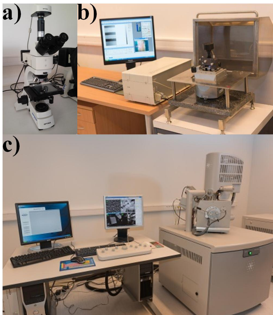
21 pav. Šiame darbe naudoti mikroskopijos metodai: a) optinis mikroskopas „B-600 MET“, b) atominių jėgų mikroskopas NT – 206 [105], c) skenuojantis elektroninis mikroskopas „Quanta 200 FEG“ [106]
