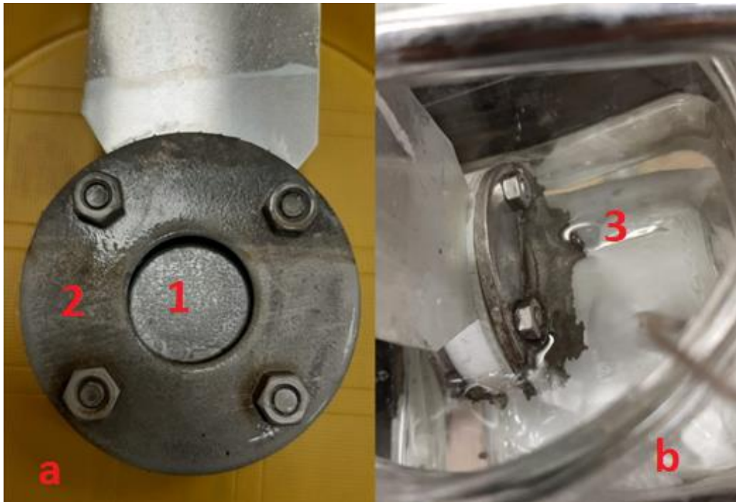
2.1.7 pav. Surinktas stovas: a) aliuminio plokštelė 1 įtvirtinta laikiklyje 2; b) aliuminio plokštelė, įtvirtinta laikiklyje, pamerkiama į rūgštinį tirpalą 3
