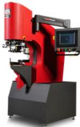
1.4 pav. Tvirtinimo detalių metalo lakštams presavimo mašina [4]
