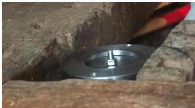
2.23 pav. Įtvirtintas prasukimo bandinys
