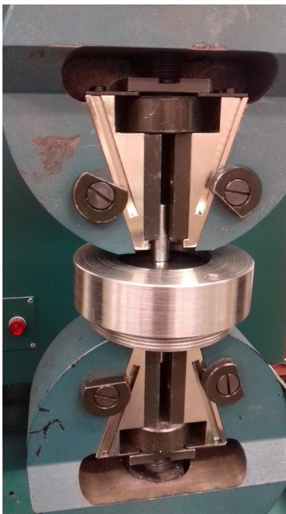
2.9 pav. Bandinys, įtvirtintas į tempimo-gniuždymo bandymų mašiną
