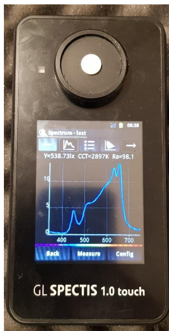
1 pav. Šviestukų spektro tyrimui naudojamas spektrografas „GL Spectis 1.0 Touch“
