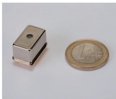
2.7 pav. „Hamamatsu C12880MA“ ypatingai mažų gabaritų spektrografo vaizdas lyginant su vieno euro moneta [27]
