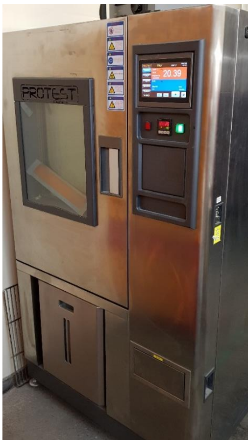
1 pav. Senėjimo eksperimentui naudojama temperatūrinio poveikio kamera „Terchy MHK-225AK“
