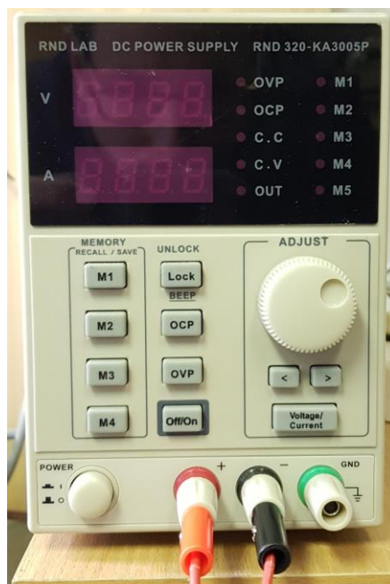
1 pav. Laboratorinis maitinimo šaltinis „RND 320-KA3005P“ (vaizdas iš priekio)
