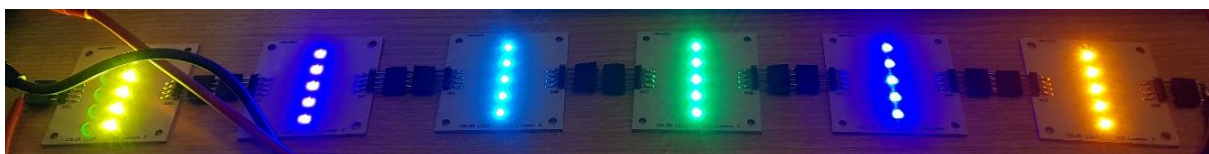
3.2 pav. Pagaminti ir funkcionuojantys skirtingų tipų šviestukų moduliai (iš kairės į dešinę: citrinų žalios, violetinės II, mėlynos, ciano, violetinės I ir gintarinės spalvų šviestukų moduliai)
