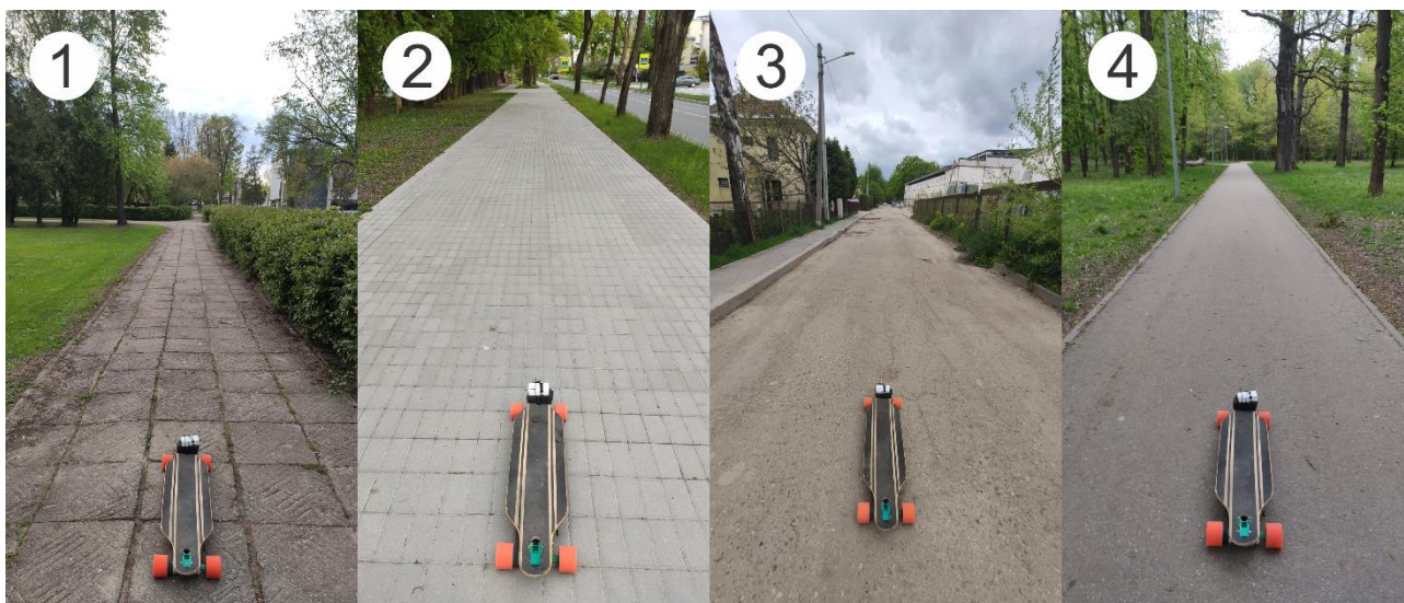
2.27 pav. Išskiriamų kelio dangų tipai: 1. Susidėvėjusiu kvadratinėmis betoninėmis plytelėmis šaligatvis; 2. Standartinių trikampinių šaligatvis; 3. Prastos būklės asfaltuota kelio danga; 4. Geros būklės asfaltuota kelio danga;
