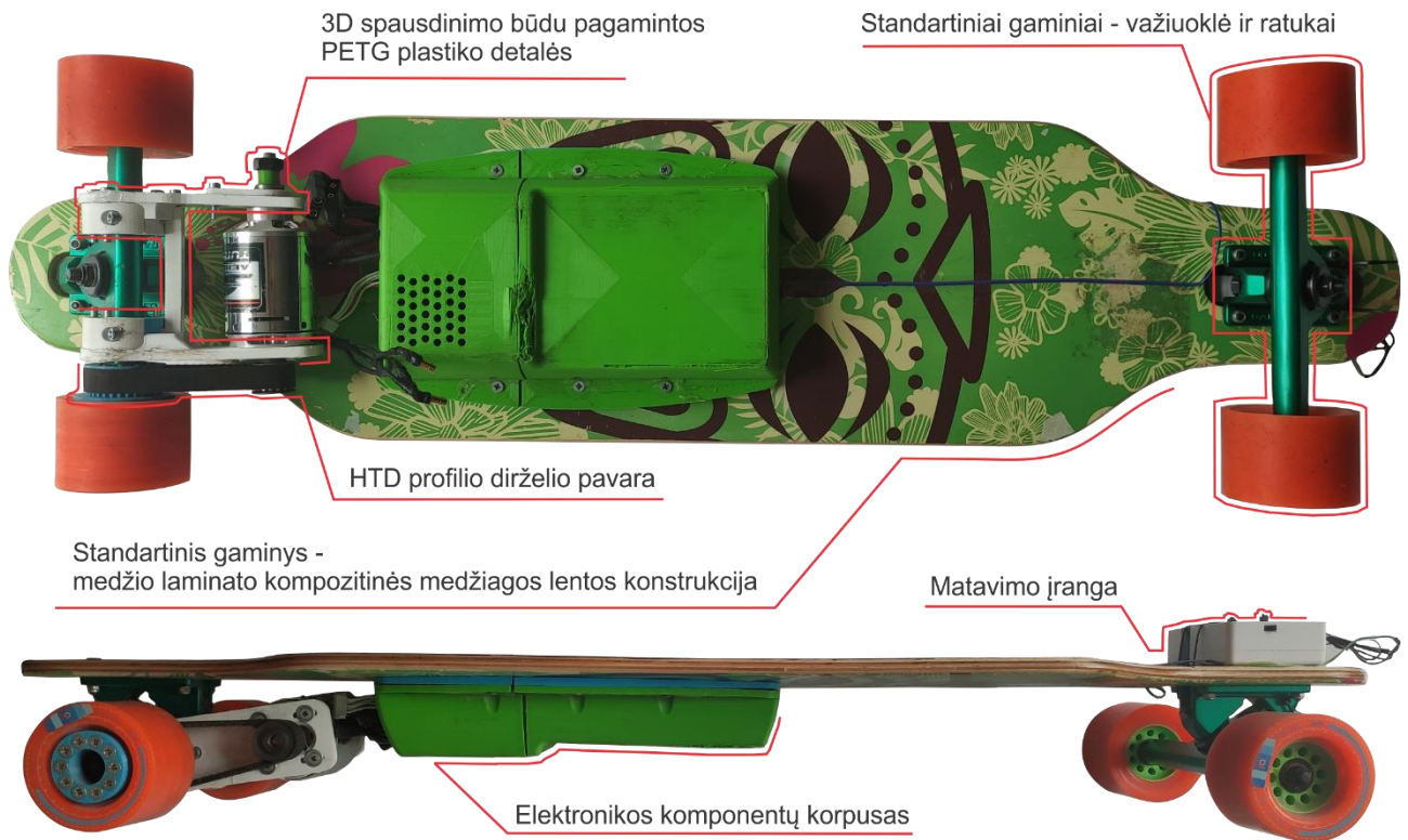
2.2 pav. Tyrimui naudotam pagamintam elektrinės riedlentės prototipui
