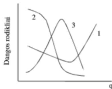
1.1.pav. Dažų dangos savybių priklausomybė nuo tūrinio pigmento kiekio \varphi : 1 – garų ir dujų pralaidumas, 2– blizgesys, 3 – tempimo stipris.
