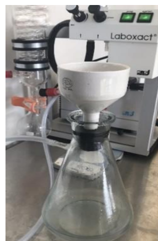
2.3 pav. Vakuuminio filtravimo sistema: Biuchnerio piltuvai ir kolba, prijungta prie vakuuminio siurblio
