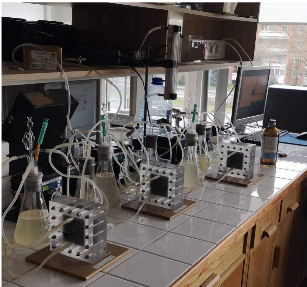
2.5 pav. Mikrobinių kuro elementų sistema: 3 mikrobiniai kuro elementai su anolito ir katolito kolbomis bei peristaltiniais siurbliais, oro pompa ir personaliniu kompiuteriu.
