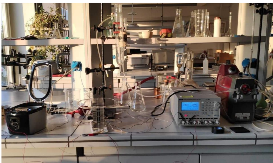
2.1 pav. Grafito pluošto veltinių oksidavimui skirta sistema: automatinis jungiklis, srautinis elektrocheminis reaktorius (SER), nuolatinės srovės šaltinis, peristaltinis siurblys (iš kairės į dešinę).
