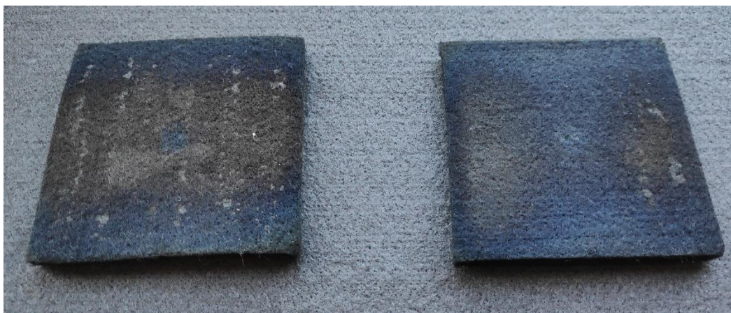
3.10 pav. Su 4,00 V ir 3,75 V įtampa oksiduoti grafito pluošto veltiniai padėti ant neoksiduoto grafito pluošto veltinio.
