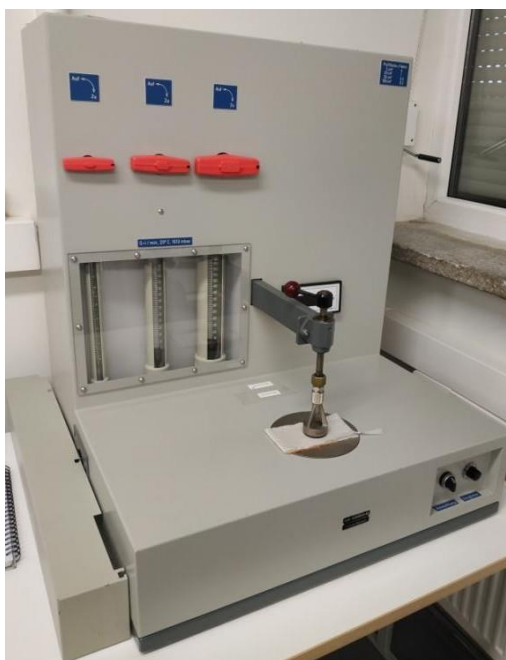
18 pav. L14DR laidumo orui matavimo prietaisas
