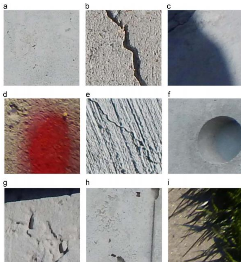
10 pav. SDNET2018 duomenų bazė sudaryta iš (a)-smulkių įtrūkimų, (b)-gilių trūkių, (c)-šėšėlių, (d)-dėmių, (e)-įtrūkimų grubiame paviršiuje, (f)-tuštumos, (g)-briaunų, (h)- jungčių ir iškorėjusių paviršių, (i)-atsitiktinių fono kliūčių;
