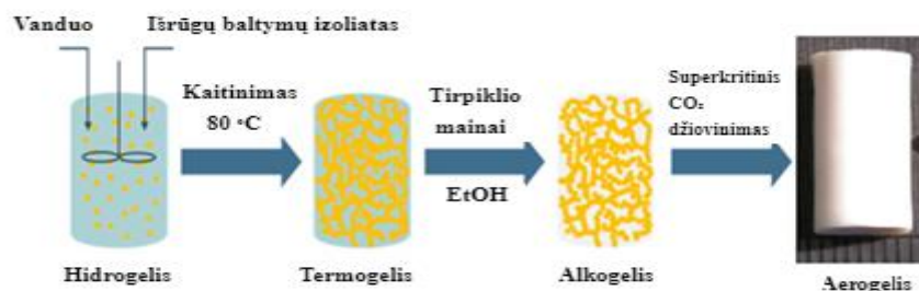
10 pav. Pagrindiniai gelio paruošimo, superkritiniam CO 2 džiovinimui, etapai
