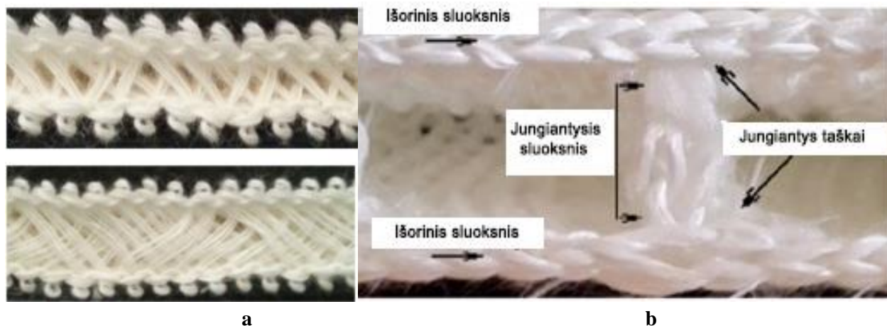
1.6 pav. Erdvinės struktūros skersiniai mežginiai: a – išoriniai sluoksniai sujungiami siūlų perdangomis, b – išoriniai sluoksniai sujungiami mežginio perdangomis [13,14]
