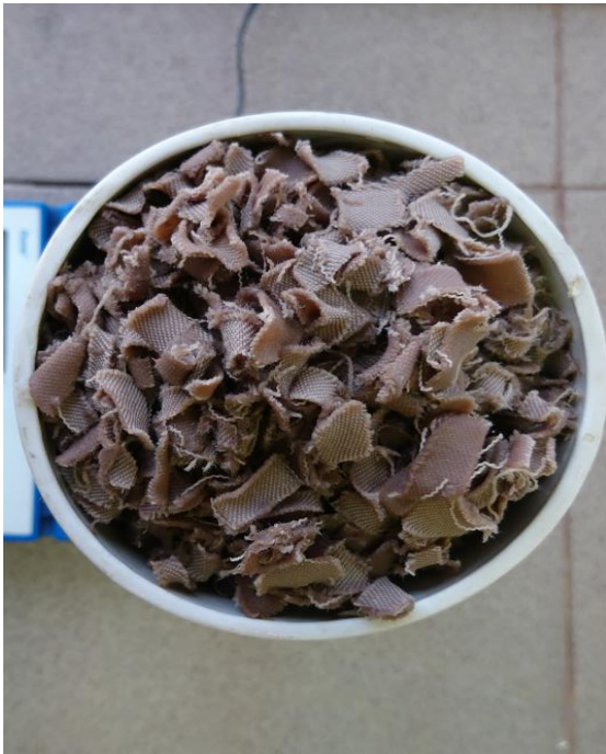
14 pav. Išskalauta medvilnė po dažų šalinimo proceso.
