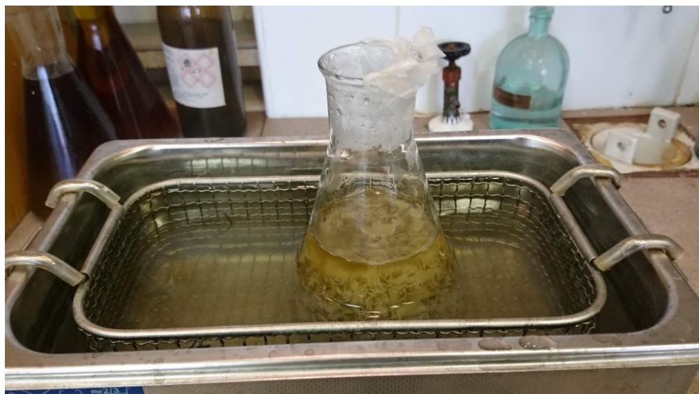
16 pav. Poliesterio ir medvilnės pluoštų atskyrimas.
