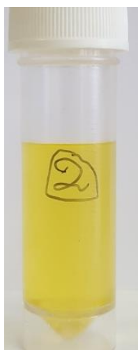
3.20 pav. Tirpalo optinės mikroskopijos nuotrauka po 4 h hidroterminio sieros etalono ir hidromagnezito mišinio apdorojimo 180 °C temperatūroje
