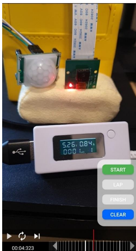
3.5 pav. Elektros energijos suvartojimo matavimas operacijos metu
