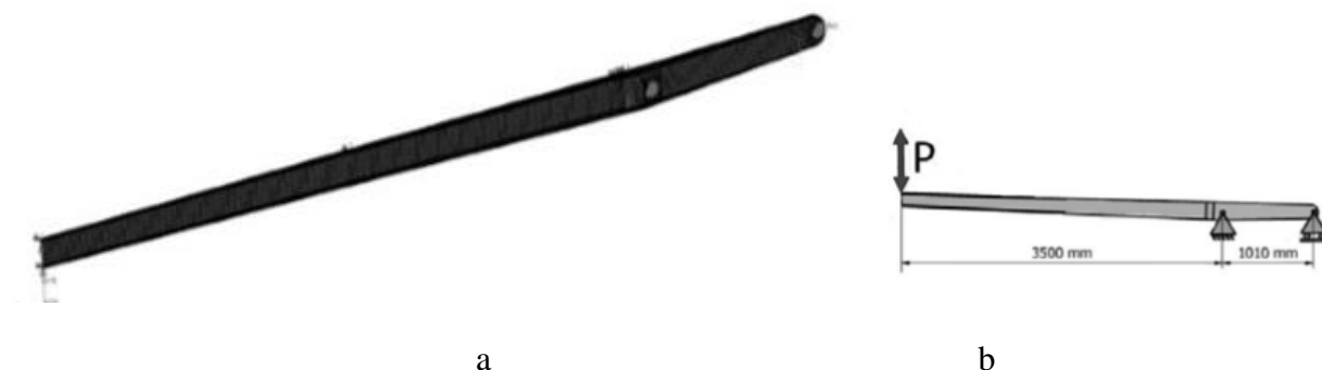
1.10 pav. Motorinio sklandytuvo kompozitinis sparno skersinis [9]: a – skaitinis modelis, b – tvirtinimo ir apkrovimo schema
