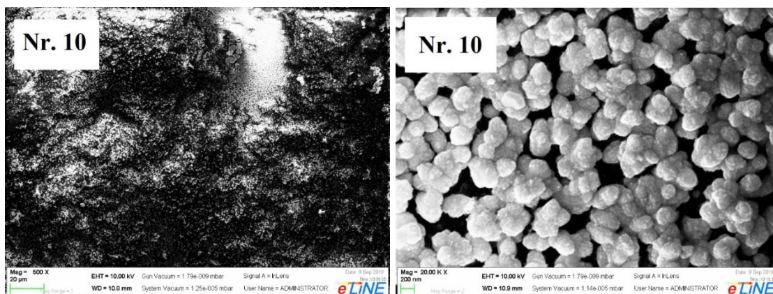
3.15 pav. Sidabro legiravimo tirpalu veiktų SnSe sluoksnių (Nr. 10) SEM nuotraukos Apdorojimo sidabro druskos tirpalu (0,1 mol/l) trukmė – 3 min, temperatūra – 80 °C
