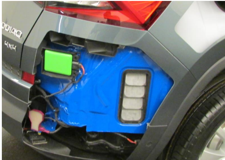
1.17 pav. Šoninio asistento sistemos radaras [2]
