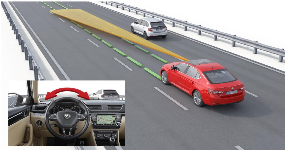
1.18 pav. Juostos palaikymo sistemos veikimas [22]
