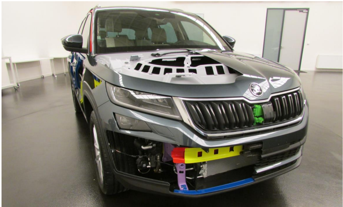
1.3 pav. „Škoda Kodiaq“ priekinės deformacinės zonos konstrukcija [2]
