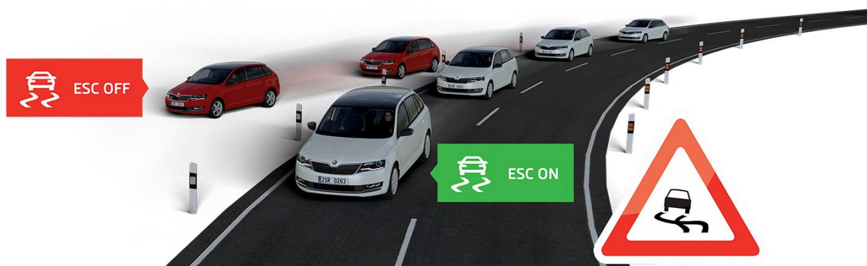
1.9 pav. „Škoda“ ESC sistemos veikimas [9]
