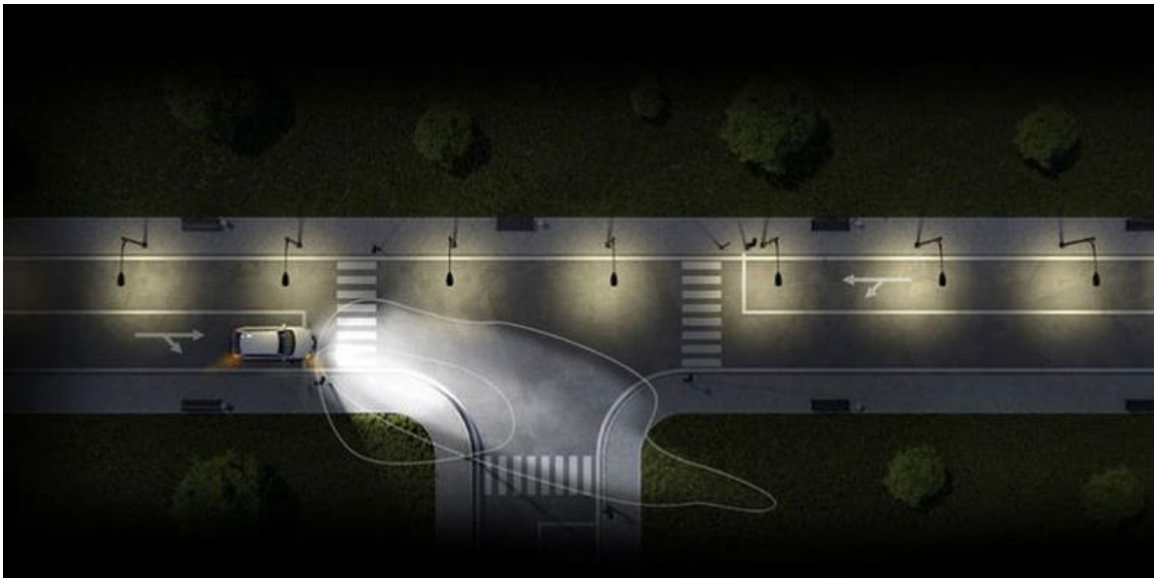
1.19 pav. Rūko žibintų posūkio funkcija [25]
