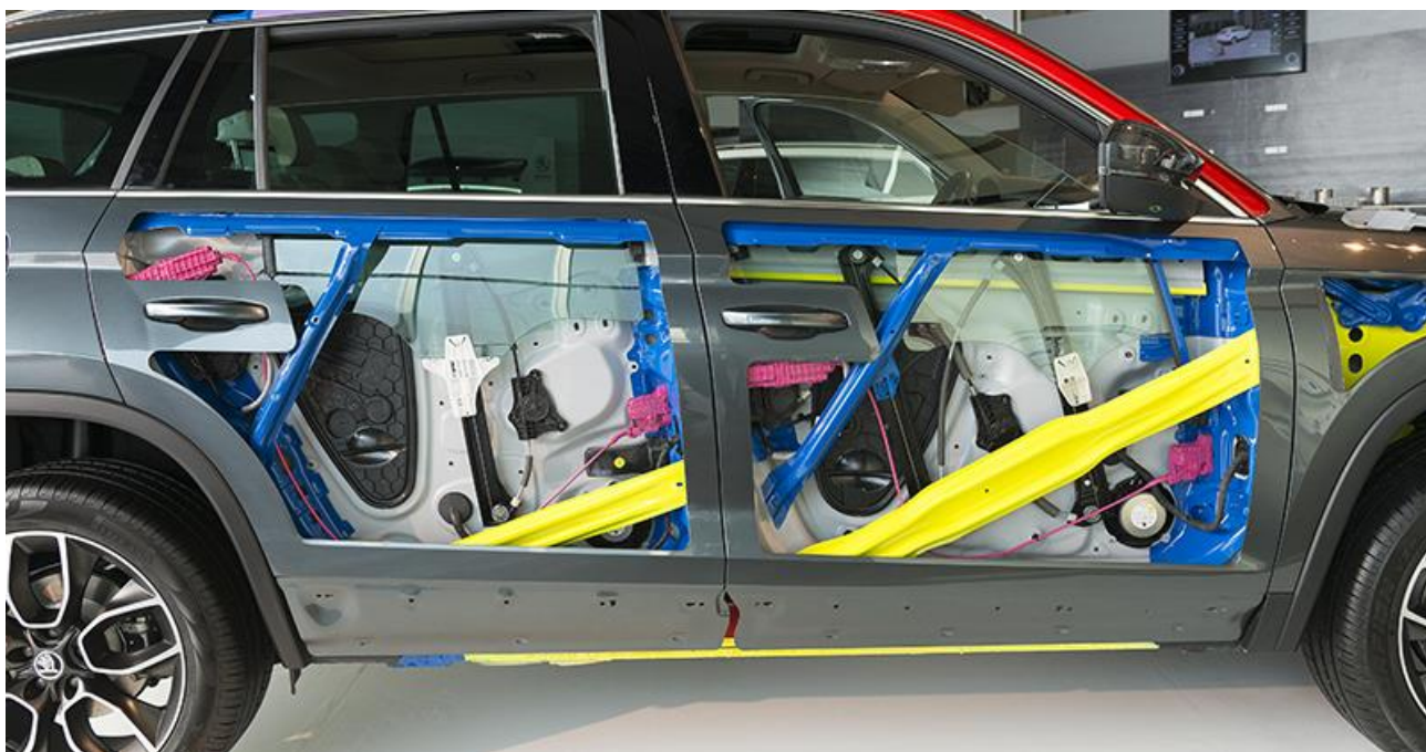
1.5 pav. Pastiprinta durų konstrukcija [2]
