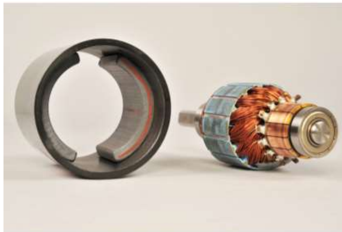
1.3 pav. Išardytas nuolatinės srovės variklis: kairėje – nuolatiniai magnetai (statorius); dešinėje – variklio besisukanti dalis (rotorius) [1]
