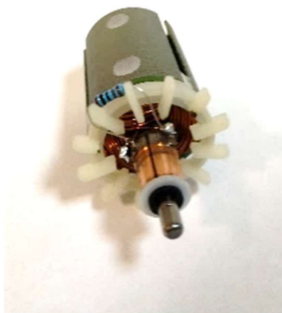
3.2 pav. Nuolatinės srovės variklio apvijų trumpas jungimas
