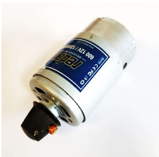
3.3 pav. Nuolatinės srovės variklio ašies disbalanso imitavimas
