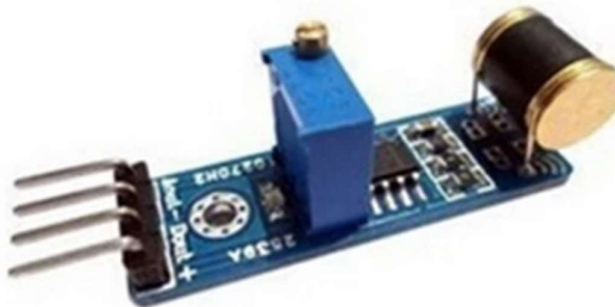
2.9 pav. Tyrime naudojamas vibracijų jutiklis
