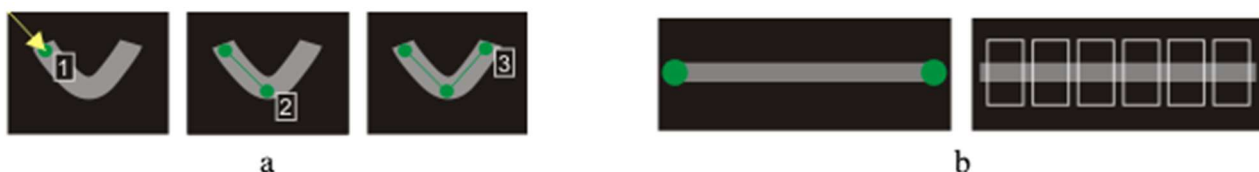
31 pav. Uždarytų briaunų patikrinimo įrankio apmokymo modelio kūrimas: a – taškų sudėjimas; b – paieškos zonų nustatymas
