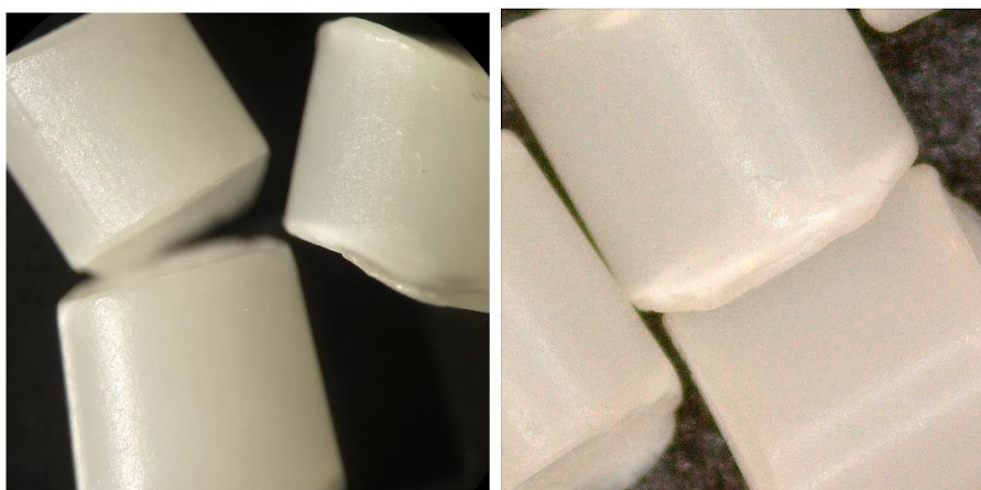
3.4 pav. Smėliu (24 val.) modifikuotos įkrovos paviršius
