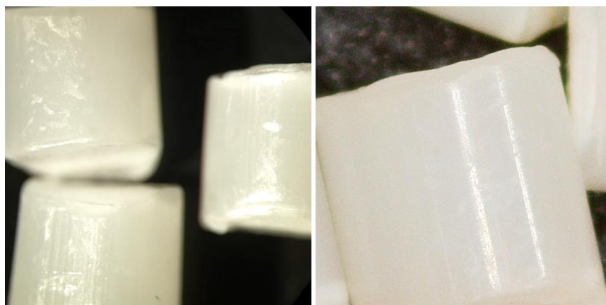
3.2 pav. Ozonatoriumi modifikuotos įkrovos paviršius
