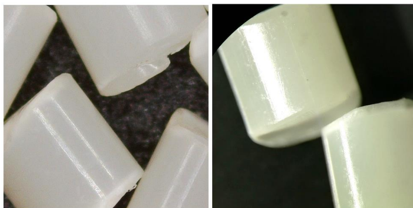
3.1 pav. Nemodifikuotos įkrovos paviršius
