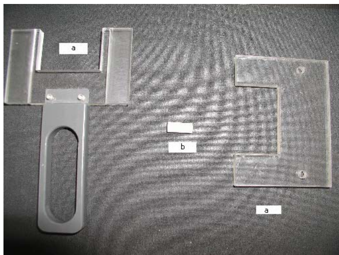
1 pav. Modifikuotas Kieffer įrenginys: a – makaronų laikymo įtaisas, b – cilindras makaronams tempti
