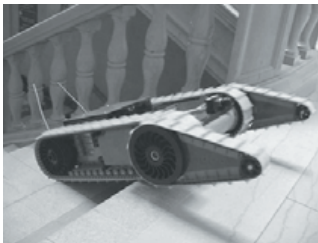
2 pav. Hibridizuota vikšrinė platforma, galinti judėti laiptais
