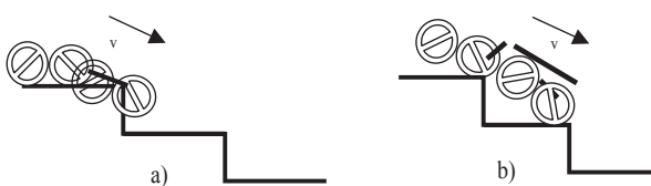
8 pav. MRR matmenų įtaka, judant laiptais į apačią: a – aukštis, b – ilgis
