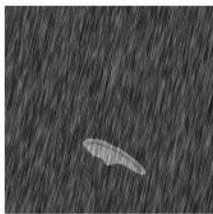
Yra defektas Defekto dydis pikseliais: 90
