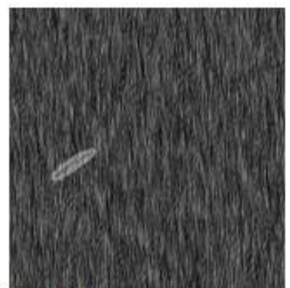
Yra defektas Defekto dydis pikseliais: 56
