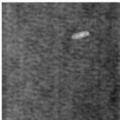
Yra defektas Defekto dydis pikseliais: 36
