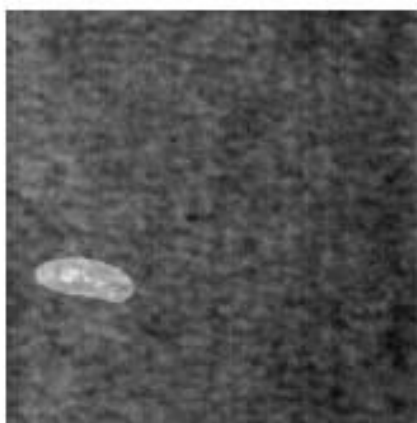
Yra defektas Defekto dydis pikseliais: 59
