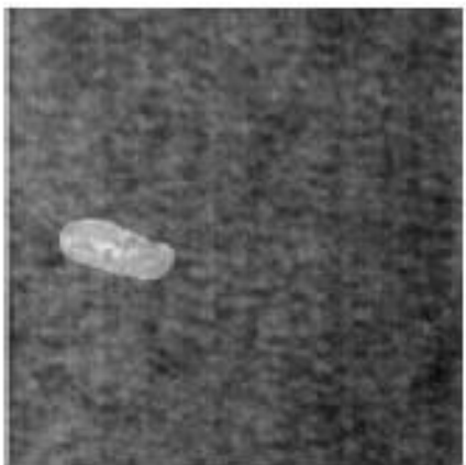
Yra defektas Defekto dydis pikseliais: 72
