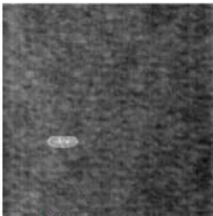
Yra defektas Defekto dydis pikseliais: 32
