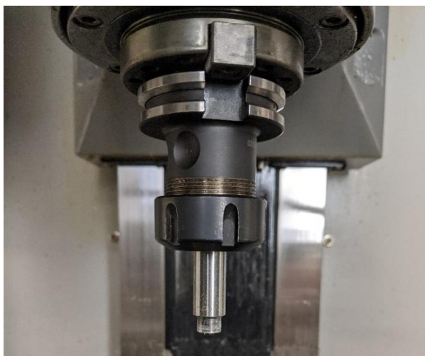
2.2 pav. Įrankis, naudotas plastiko frikcinio maišymo suvirinimui
