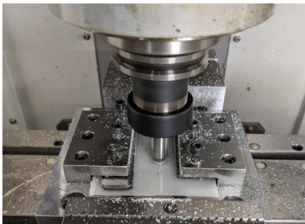
2.5 pav. PE plastiko frikcino maišymo suvirinimo bandymas
