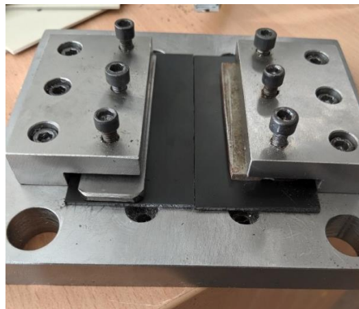
2.4 pav. Plokštelių įtvirtinimas laikiklyje
