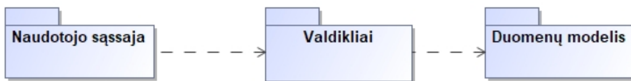
3.12 pav. Sistemos loginė architektūra
