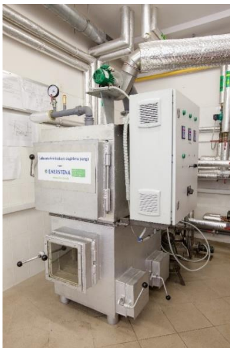
2.2.1 pav. Biokuro katilo modelis – deginimo stendas „Enerstena“
