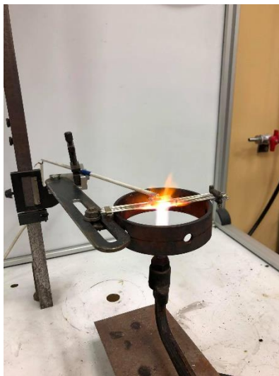
10 pav. Tyrimo stovas su termopora ir degiklis
