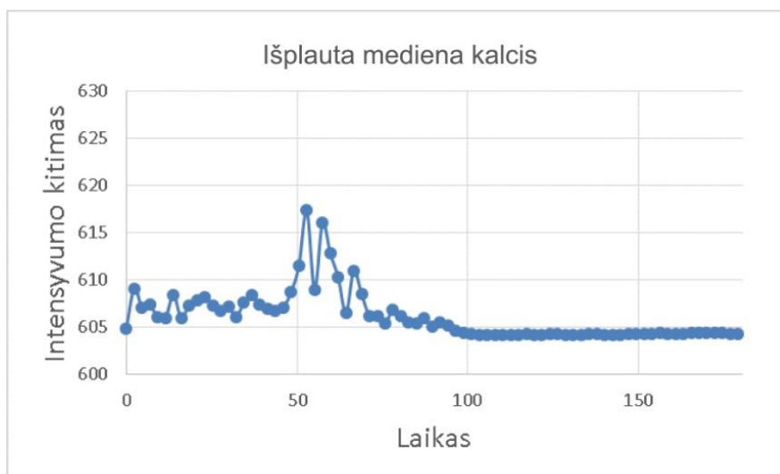
20 pav. Išplautos medienos kalcio filtro bandymų rezultatai
