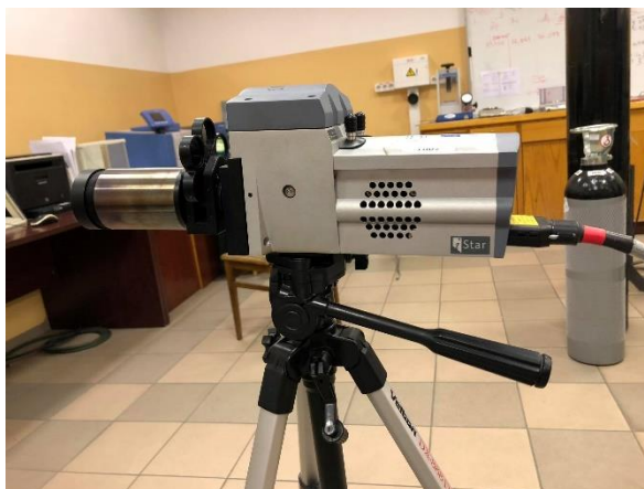
12 pav. Andor iStar ICCD kamera su stovu ir detektoriumi
