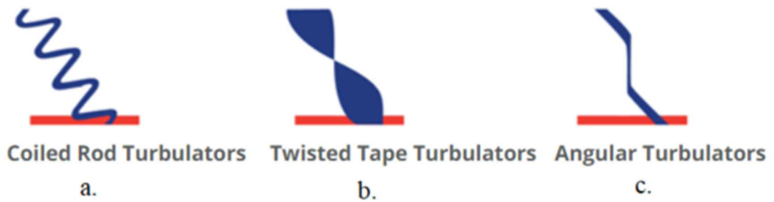
2 pav. Dūmavamzdžiuose šilumokaičiuose naudojami turbulizatoriai: a) spiralės tipo; b) susuktos juostos tipo; c) kampuoto tipo
