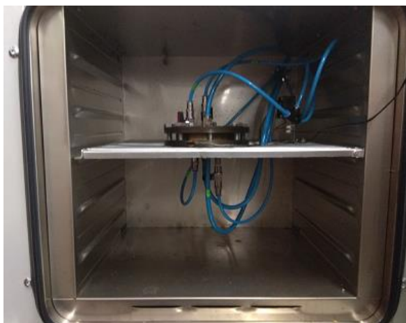
21 pav. Membranos modulis patalpintas termokameroje
