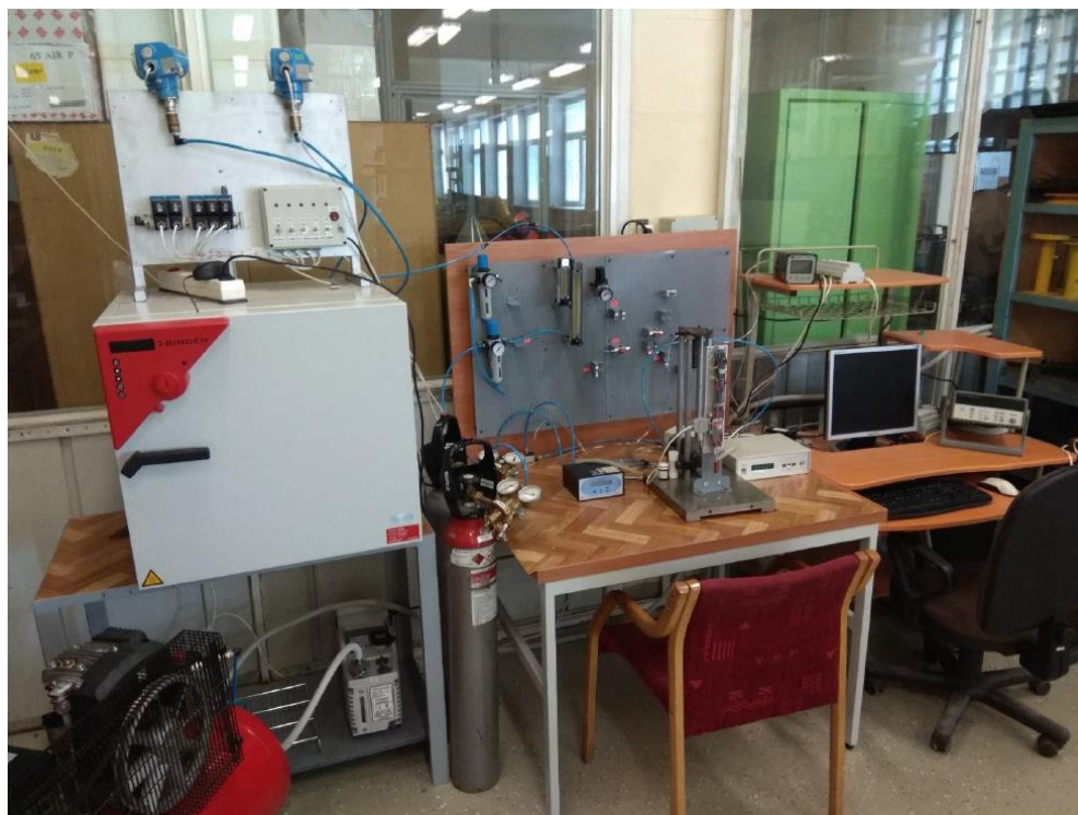
13 pav. Įrenginys skirtas polimerinių membranų tyrimams
