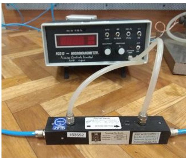
26 pav. Laminarinio srauto elementas su mikromanometru FCO12
