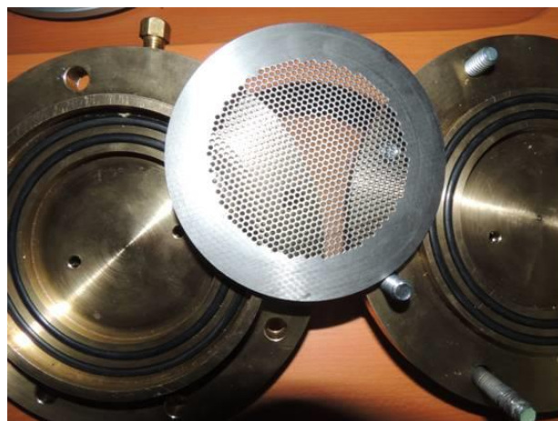
22 pav. Membranos modulio pertvara bei dangčiai
