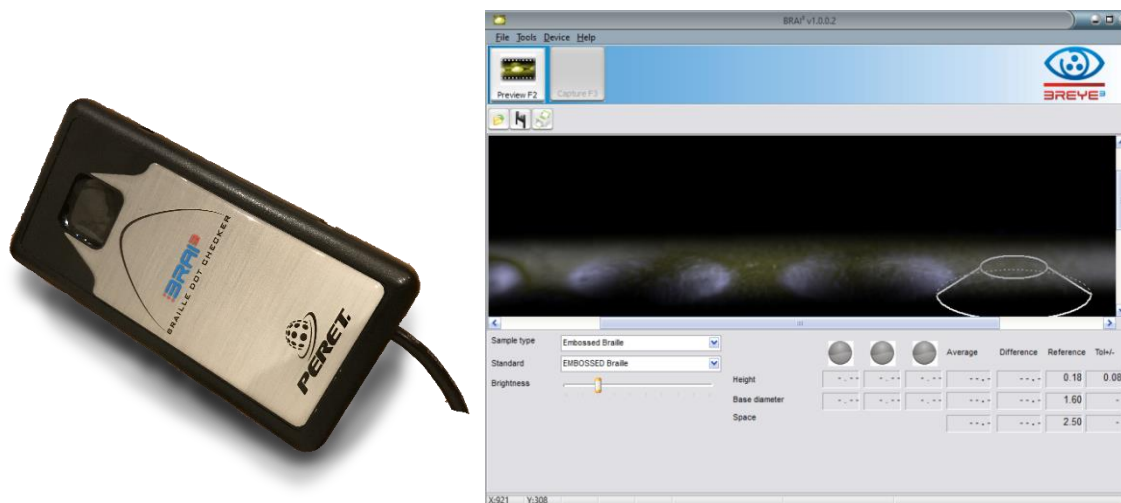
3 pav. „Brai 3 Braille Dot Checker“ prietaisas ir vaizdas kompiuterio ekrane [19]
