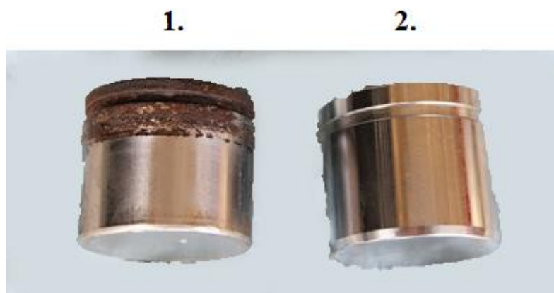
8 pav. Korozijos pažeistas stabdžių cilindro stūmokliukas, pažymėtas 1 Nr., ir naujas stūmokliukas, pažymėtas 2 Nr. [10]
