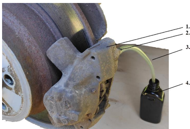
31 pav. Stabdžių skystis perpumpuojamas iš automobilio rato stabdžių cilindro į indą stabdžių skysčio mėginiui. 1. Rato stabdžių cilindras. 2. Rato stabdžių cilindro oro pašalinimo vožtuvas. 3. Žarnelė stabdžių skysčio perpumpavimui į stabdžių skysčio mėginiui skirtą indą. 4. Stabdžių skysčio mėginiui skirtas indas
