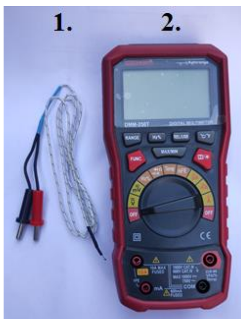
20 pav. Stabdžių skysčio virimo temperatūros matavimui naudoti prietaisai. 1. Termopora. 2. Multimetras TESTMATE DMM – 250T
