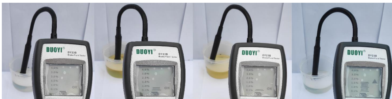
23 pav. 1 dalis drėgmės kiekio matavimo prietaiso parodymų naujame stabdžių skystyje
