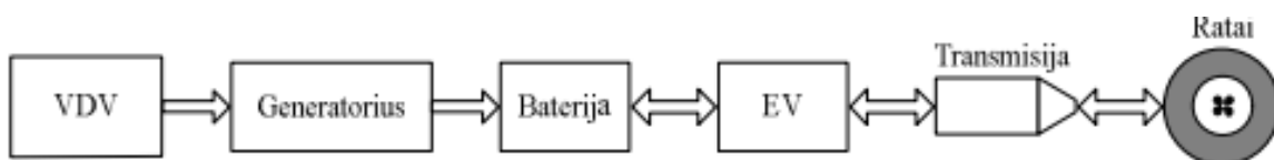
4 pav. Galios perdavimo schema, nuoseklus jungimas (hibridinis automobilis) [32]
