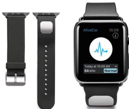
1.9 pav. „KardiaBand“ veikimui reikalingos apyrankės pavyzdys [24].
