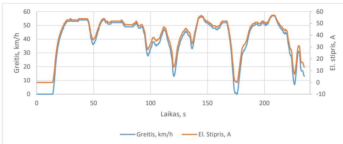
3.20 pav. 40 kWh Baterijos iškrovos ir įkrovos priklausomybė nuo važiavimo greičio
