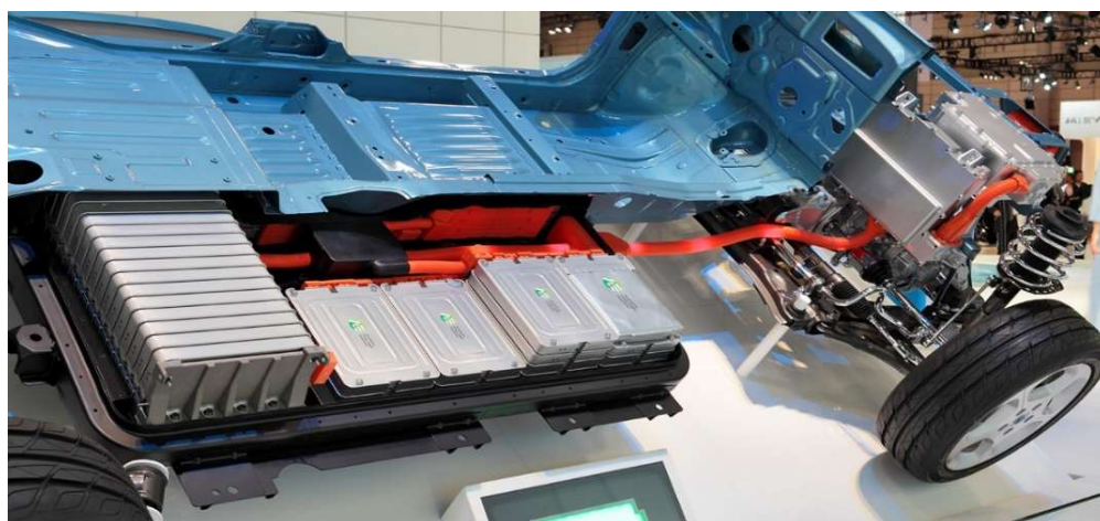
1.6 pav. Nissan Leaf automobilio Ličio Jonų akumulatoriaus celių išdėstymas 2009m.
