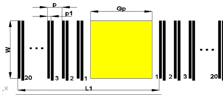
Fig. 2. CMUT biosensor layout
