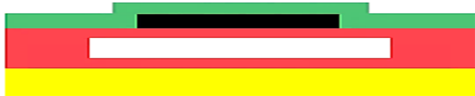
1 pav. CMUT celių surinkimas, taikant aukojamojo sluoksnio technologiją. Spalvos: geltona – silicis, raudona – silicio oksidas, juoda – Ti/Au, žalia – silicio nitridas; balta spalva – vakuumo tarpelis
