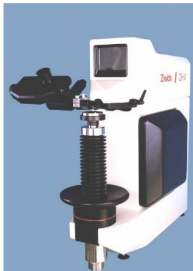
25 pav. Kietumo matavimo įrenginys Indentec 5030KV (Zwick/Roell, Germany) [50]
