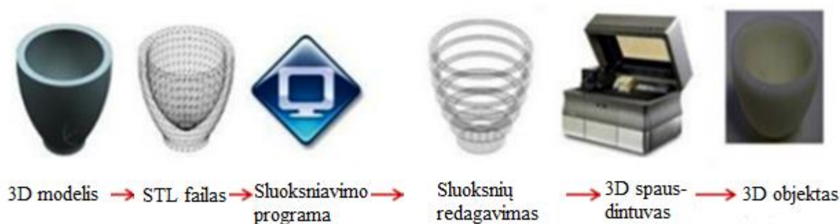
17 pav. 3D spausdinimo procesas (nuo modelio sukūrimo iki atspausdinto objekto) [11]
